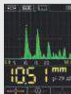
Предназначен для проведения измерений с выводом на дисплей прибора сигналов в виде А-Скана. Режим позволяет исключить неточности в измерениях, вызванные удвоением показаний. Возможны четыре способа измерений: первое превышение сигналом строба, положение максимума в стробе, между двумя сигналами и АКФ по стробу. Выбор способа измерения «между двумя максимумами» позволяет осуществлять толщинометрию металла через пластиковые (полиэтиленовые) и лакокрасочные покрытия без зачистки.
