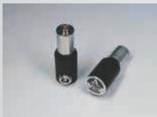
Преобразователи с сухим точечным контактом для реализации сквозного и поверхностного прозвучивания объекта контроля:
