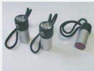
Преобразователями с жидкостным контактом для сквозного прозвучивания:
