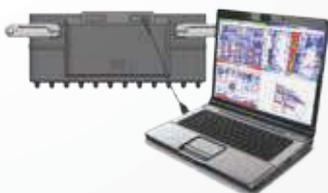
Прибор имеет встроенный компьютер, позволяющий обрабатывать данные непосредственно в процессе работы, представлять их на экране и сохранять в памяти.
