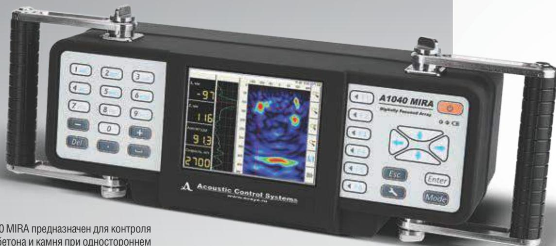
Ультразвуковой томограф A1040 MIRA предназначен для контроля конструкций из бетона, железобетона и камня при одностороннем доступе к ним с целью определения целостности материала конструкции, поиска инородных включений, полостей, непроливов, расслоений и трещин, а также измерения толщины объекта контроля. Возможен контроль объектов толщиной до 2,5 метров.
