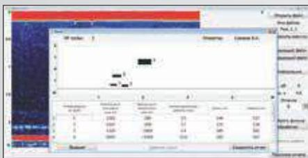
По окончании сканирования трубы оператор выделяет аномальные области, на основе которых формируется отчет с координатами обнаруженных дефектов и схемой их расположения на трубе.
