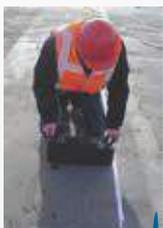
Контроль проводится по схеме пошагового сканирования объекта контроля с объединением данных и реконструкцией объема под всей отсканированной площадью объекта контроля.
