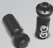
**Раздельно-совмещенный преобразователь D2763 10.0A0D6CL** обеспечивает поиск мест язвенной коррозии и измерение толщин тонкостенных труб малого диаметра.
