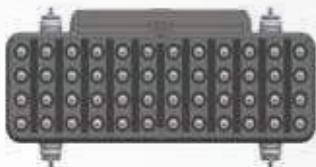
Томограф для бетона A1040 MIRA представляет собой полностью автономный измерительный блок для сбора и томографической обработки полученных данных. Измерительный блок содержит матричную антенную решетку из 48 низкочастотных широкополосных преобразователей
