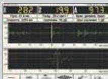
**Возможность представления сигнала в недетектированном виде** – сигнал типа RF (радиосигнал) в реальном масштабе времени, что позволяет подробно изучить фазы сигналов, проводить контроль на фоне больших структурных помех и разделять сигналы от близкорасположенных отражателей.
